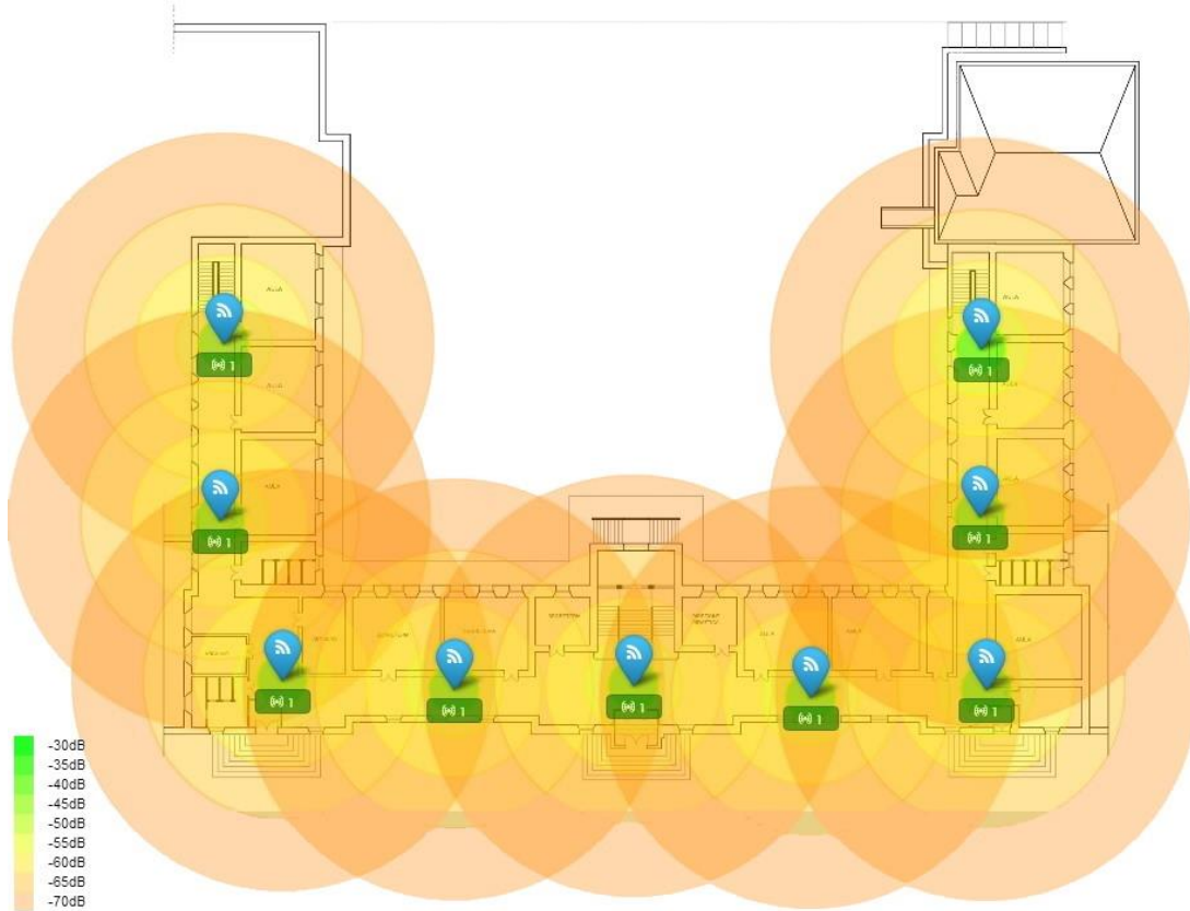
8.3 - Plesso IRIS ORIGO - Piano Terra - Copertura 2.4 GHz
